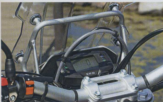
Puristisches Cockpit mit ergonomischen Schwächen – die Bremsleitung liegt beim Fahren genau im Sichtfeld
