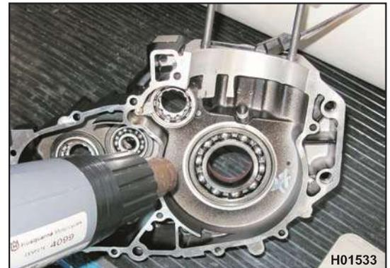
Die Kettenradlagerbuchse (15) einfetten und in das Lager einbauen; Passend für die Linke Kurbelgehäusehälfte auf die rechte Kurbelgehäusehälfte aufsetzen.
