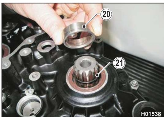
Einsatzbuchse (20) mit O-Ring (21); Die O-Ring-Nut muss nach innen in den Motor zeigen
