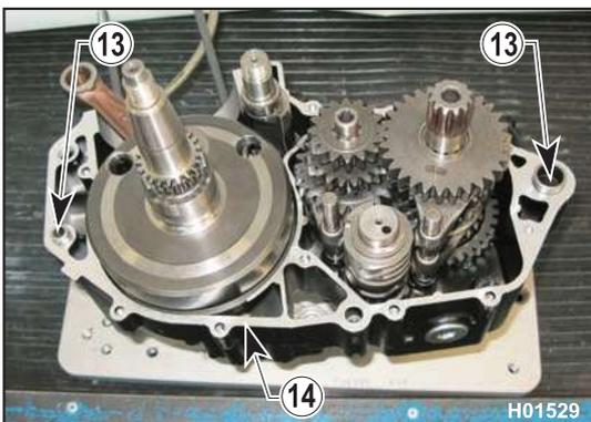
Stellen Sie sicher, dass beide Kurbelgehäuse-Aufnahmebuchsen (13) an Ort und Stelle sind.
