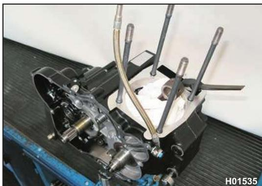
Decken Sie den oberen Bereich des Motors mit einem Tuch, einem Schwamm oder ähnlichem ab, um zu verhindern das Schrauben oder andere Teile versehentlich in den Motor fallen.
