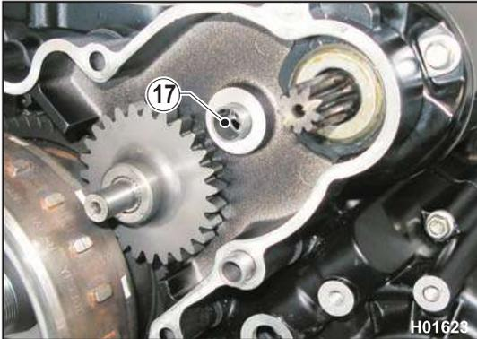
Buchse (17) und Anlasserantrieb (18) montieren.
