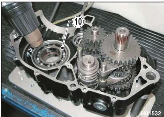
Das Kurbwellenlager (10) erwärmen und die Kurbelwelle (11) einbauen.
