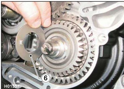
Setzen Sie die Sicherungsscheibe (6) auf das Kurbelwellenrad und achten Sie darauf,
