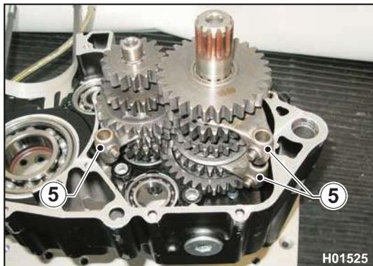
Schmieren Sie die Schaltgabeln (5) mit Motoröl und bauen Sie sie ein.
