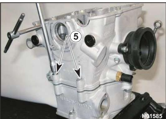
Ziehen Sie die beiden Zylinderkopfschrauben (5) mit einem 8-mm-Schlüssel fest
