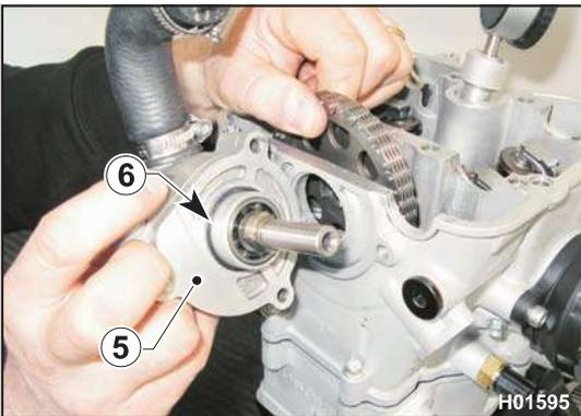
Setzen Sie die Wasserpumpe (5) auf den Kopf ein; Den O-Ring (6) auf Beschädigungen prüfen. Schrauben (7) mit einem 8-mm-Schlüssel auf 8 Nm anziehen; 0,8 kgm; 5,8 ft/lb + Loctit 542
