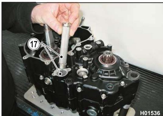
Siebfilter (17) und deren Abdeckung (18) einbauen und die Schrauben (19) mit einem 8-mm-Schlüssel (siehe Abschnitt "X" für die Anzugsdrehmomente).
