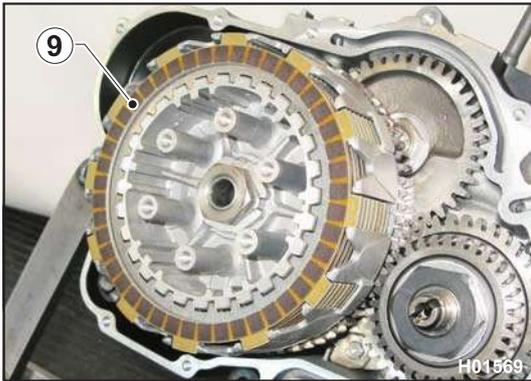
Montieren Sie die Lamellen (9) wieder (montieren Sie zuerst eine Reibplatte und dann eine Stahlplatte und halten Sie abwechselnd mit Reibungs- und Stahlplatten; Der letzte, der hineingeht, sollte ein Stahlplatte sein. Betätigungsplatte (10), Axiallager (11), Anlaufscheibe (12), Druckring montieren .
